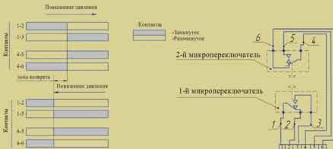
Пружина настроечная имеет рабочий ход, которым обеспечивается весь диапазон настройки (от нижнего значения давления до верхнего). Произвести настройку на определенное значение давления - нижней уставки - 1-м микропереключателем, и настройку верхней уставки - 2-м микропереключателем. В сети давление «0», контакты «1-2» замкнуты, «1-3» разомкнуты. При повышении давления и достижении «нижней уставки» контакты 1-го микропереключателя «1-2» размыкаются, «1-3» замыкаются.
