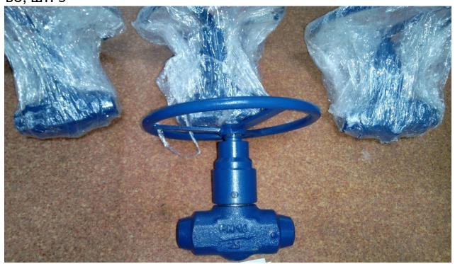
1.42 Вентиль стальной запорный проходной фланцевый
