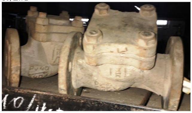
4.10 Клапан обратный подъемный фланцевый
